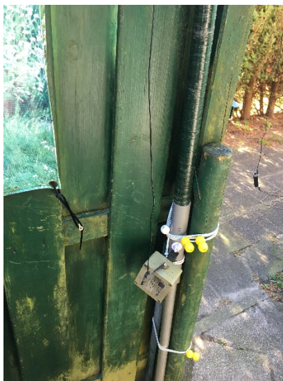
Aan de mast een end fed antenne van 11,5 meter.
