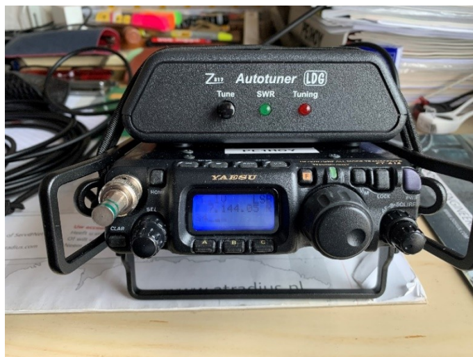
FT 818 en de LDG tuner.
